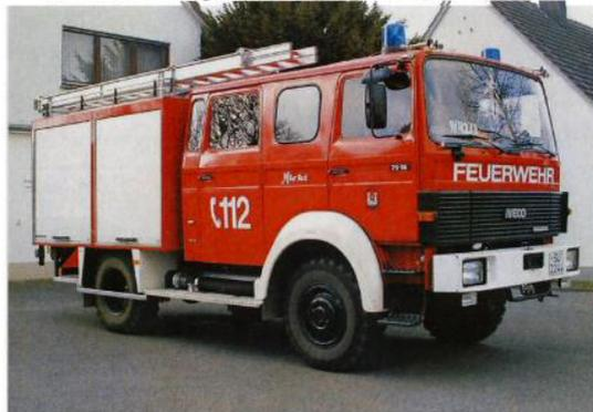
Löschgruppenfahrzeug mit 1/8 Besatzung, mit 124KW // 170PS
